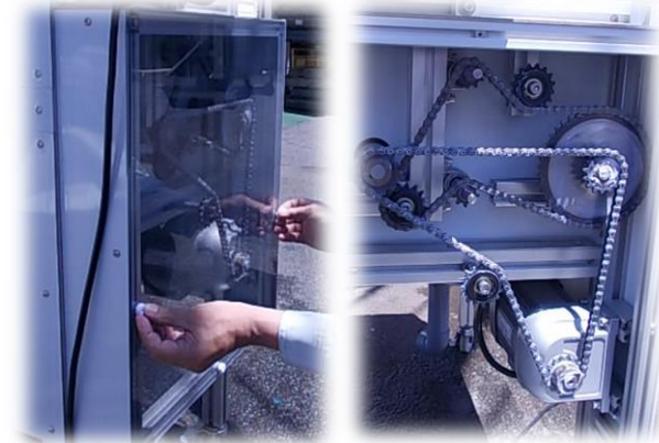
駆動部スケルトンによりメンテナンスが容易
